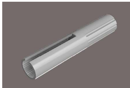
Рисунок 1 – Цифровая модель и внешний вид инструмента для установки фитингов
