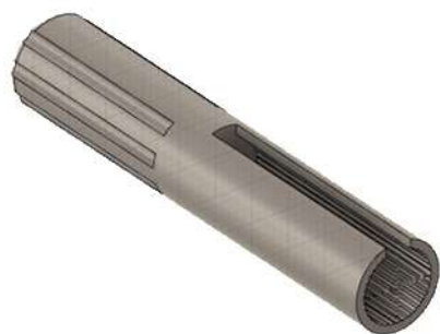
Рисунок 1 – Цифровая модель и внешний вид инструмента для установки фитингов
