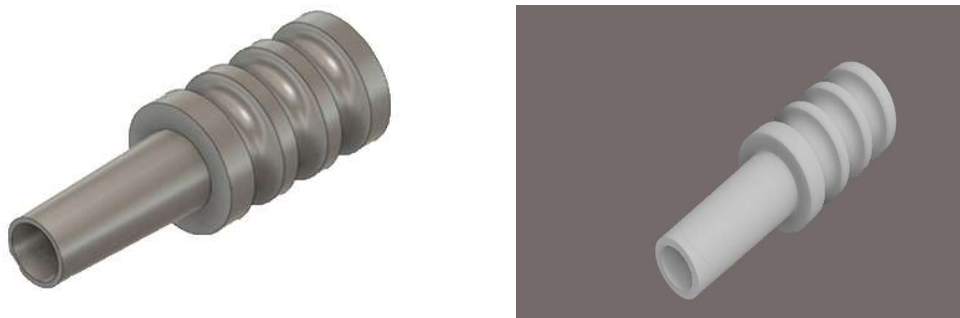
Рисунок 3 – Цифровая модель и внешний вид переходника стеклянный фильтр-капилляр
