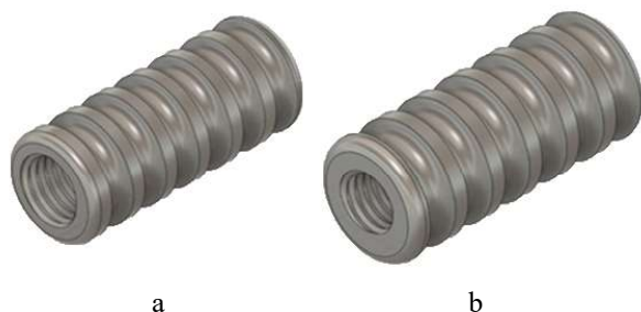
Рисунок 2 – Цифровая модель и внешний вид переходников шприц-капилляр: а – переходник с резьбой ¼-28, б – переходник с резьбой 10-32
