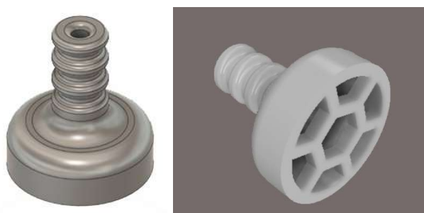
Рисунок 4 – Цифровая модель и внешний вид фильтров для подвижной фазы
