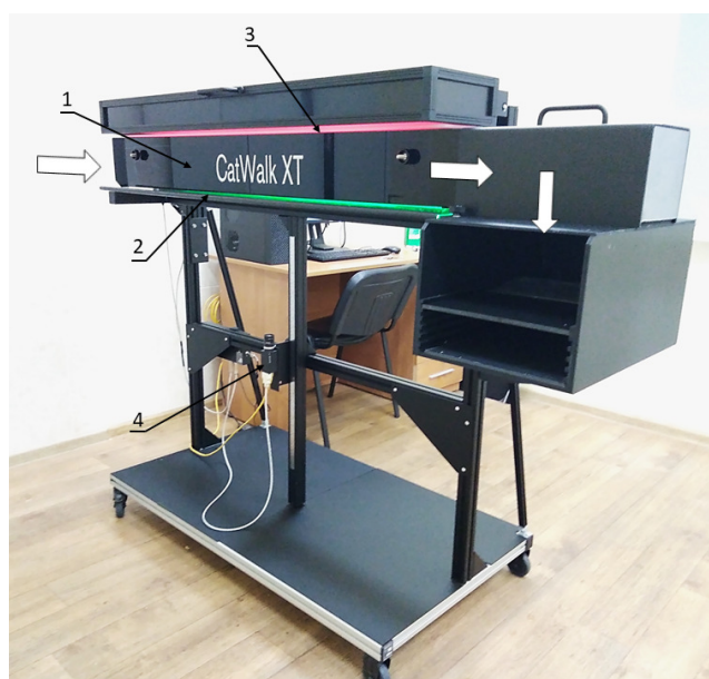
Рисунок 1 – Система анализа походки CatWalk XT: 1 – коридор; 2 – стеклянный пол с зеленой LED подсветкой; 3 – потолок с красной LED подсветкой; 4 – видеокамера. Белыми стрелками показано направление движения экспериментального животного
