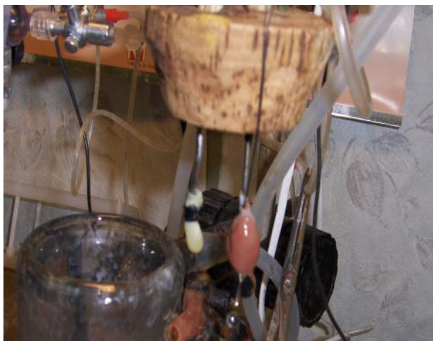
Рис. 3. Перфузия изолированного сердца крысы по Лангендорфу.
